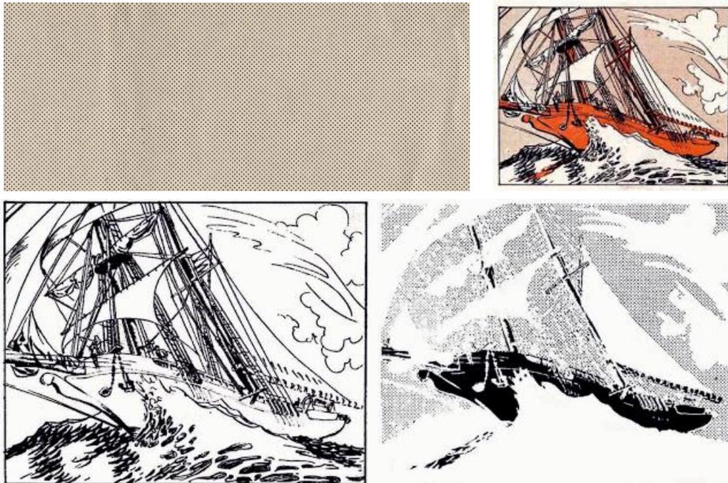
Primeiro, a trama mecânica impressa em papel acetinado. Embaixo, à esquerda, o desenho original (de uma HQ de Vitor Silva). Embaixo, à direita, a definição da cor feita com guache e nanquim sobre a trama mecânica. Em cima, à direita, o quadro impresso com as duas cores.
