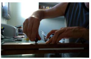
OS CADERNOS SÃO COLOCADOS NUMA PRENSA FORMADA POR DOIS BARROTES DE MADEIRA COM PARAFUSOS BORBOLETA. A PRENSA SERVE PARA PERFILAR OS CADERNOS PARA A COLAGEM.
